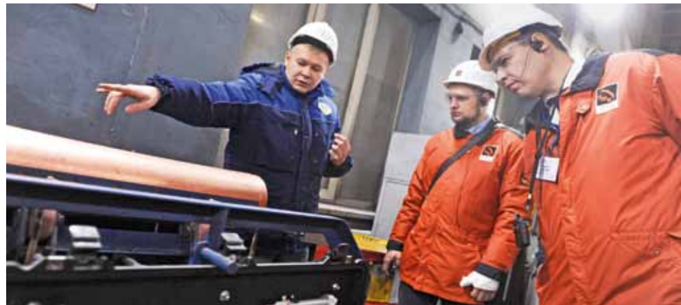
Заместитель начальника цеха ремонта металлургического оборудования и печей Полевского Технического Сервиса Сергей Рыжков (слева) демонстрирует в работе установку по проверке основных технических параметров медных гильз
