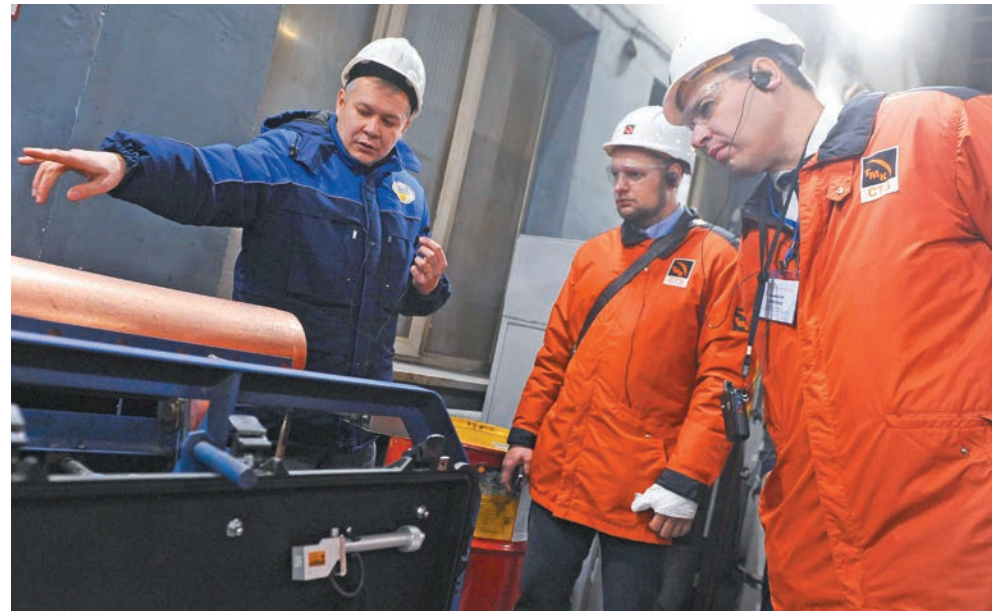
Зам начальника ЦРМОИП Полевского Технического Сервиса Сергей Рыжков (слева) демонстрирует в работе установку по проверке основных технических параметров медных гильз
